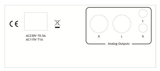
从左到右分别是:电源输入端口,右声道模拟平衡输出端子,左声道模拟平衡输出端子,模拟 RCA输出端子。
