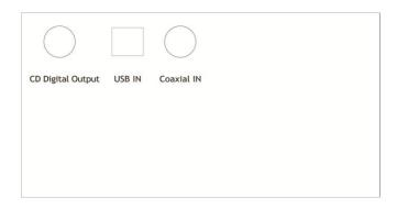
位于 CD 机侧面,从左到右分别为: CD 同轴输出,解码器 USB 数字输入,同轴数字输入端口。
